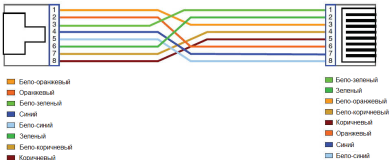
Рис.9 Обжимка кабеля по типу TIA/EIA-568-B.
