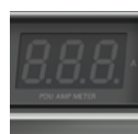
Амперметр Код артикула: AM Амперметр (цифровой, переменного тока) Максимальный ток: 16А (переменный ток) Предел измерений: 20А (переменный ток) Точность измерений: ±1,0% Шаг измерений: 200мА Частота: 50-60Гц Количество знаков на дисплее: 3 Дисплей: светодиоды красного цвета Питание: 250В (переменный ток)
