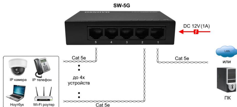
Рис. 4 Типовая схема подключения коммутатора SW-5G.
