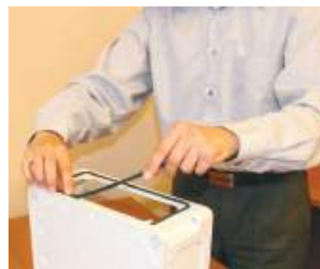
3. Установите уплотнитель на оба объединяемых корпуса
