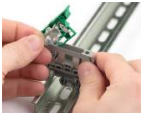
2. Установите защитный экран
