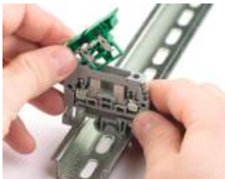
1. Установите контакты и плату LED-индикатора
