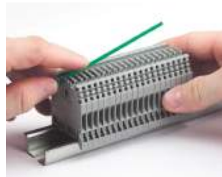
3. Отрежьте маркировочную ленту ZPTC0990 необходимой длины и установите поверх перемычки
