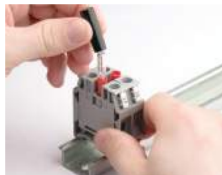
3. Закрепите прижимным винтом проводник в щупе
