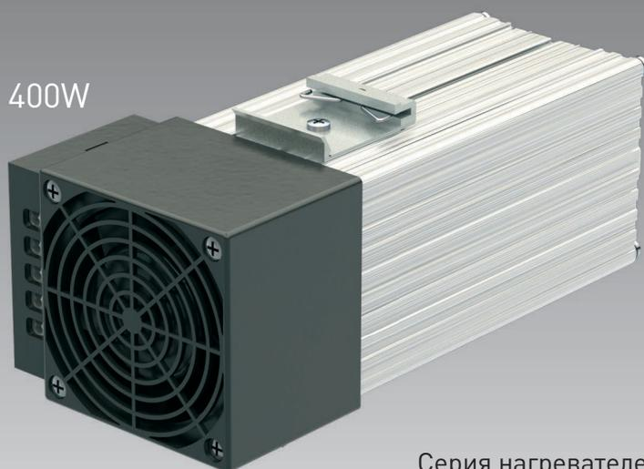
Нагреватели применяются в шкафах, где должна быть предотвращена угроза образования конденсата или температура не должна опускаться ниже определенного значения. Конструкция алюминиевого профиля обеспечивает естественную тягу, благодаря чему достигается равномерное распределение температуры в электротехнических шкафах.
