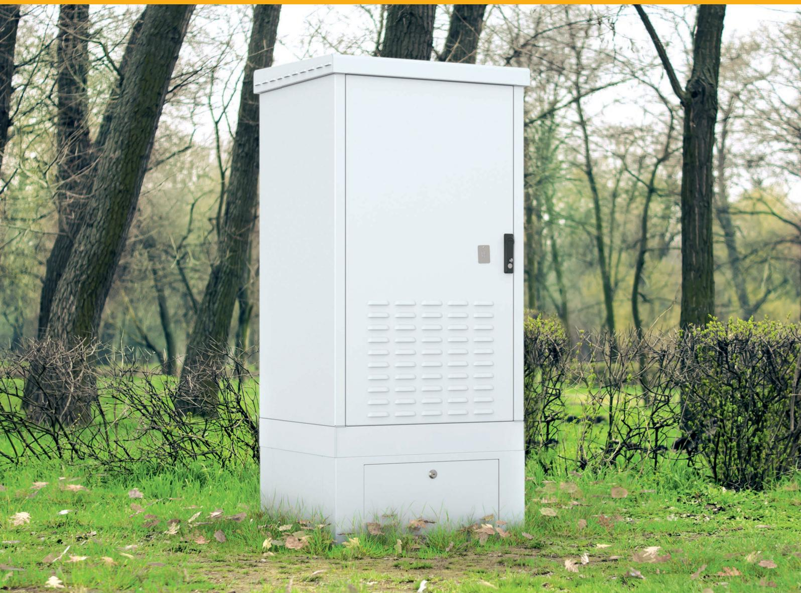
Крыша шкафа съёмная, имеет небольшой уклон и систему «антикапля», что не позволяет воде скапливаться на шкафу и стекать без попадания на уплотнитель шкафа (благодаря чему дверь не примерзнет при отрицательных температурах).
