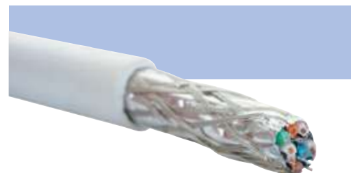
КОНСТРУКЦИЯ КАБЕЛЯ: МНОГОВИТОВЫЙ S/FTP КАТЕГОРИИ 6A, КАЛИБР 26 AWG И МАЛЫЙ ВНЕШНИЙ ДИАМЕТР КАБЕЛЯ ОБЕСПЕЧИВАЮТ ВЫСОКУЮ ГИБКОСТЬ ШНУРОВ И МИНИМАЛЬНЫЙ ОБЪЕМ.
