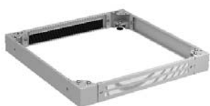
Цоколь высотой 100 мм с перфорированной панелью, установленной спереди, и с задней панелью, оснащенной щеточным вводом
