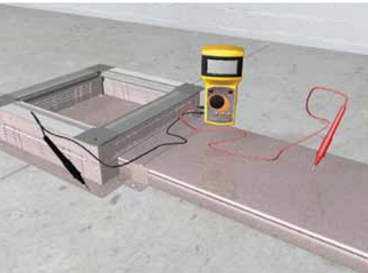
Проверьте заземление в UDS/UDB
