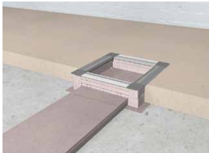
Установка в цементную стяжку
