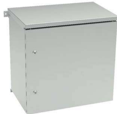
Шкаф SWN IP 65 с монтажной панелью, 19-дюймовыми монтажными профилями и защитной крышкой от воздействия осадков, изготовленный из нержавеющей стали. Внешние размеры: высота (с крышкой) 606 мм, ширина 600 мм, глубина 400 мм. Полезная высота 12U
