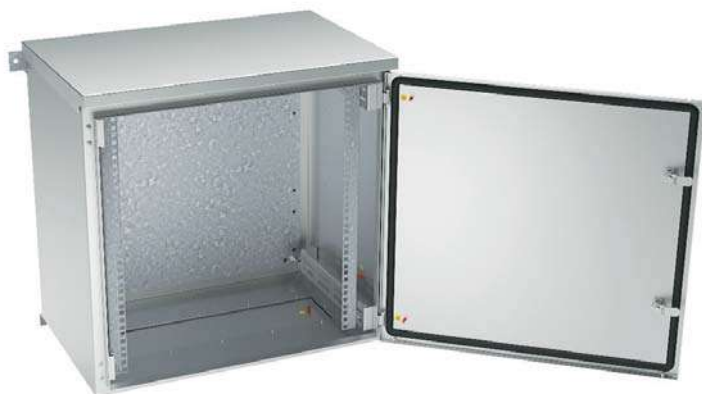
Шкаф SWN IP 65 с монтажной панелью, 19-дюймовыми монтажными профилями и защитной крышкой от воздействия осадков, изготовленный из нержавеющей стали. Внешние размеры: высота (с крышкой) 606 мм, ширина 600 мм, глубина 400 мм. Полезная высота 12U
