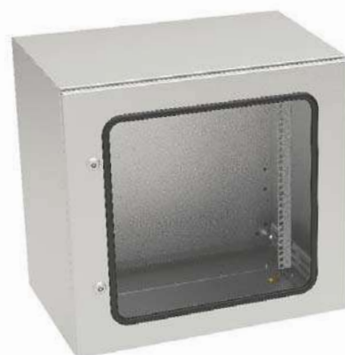
Шкаф SWN IP 65 с монтажной панелью и 19-дюймовыми монтажными профилями, окрашенный порошковой краской цвета RAL 7035. Внешние размеры: высота 575 мм, ширина 600 мм, глубина 400 мм. Полезная высота 12U. Исполнения со сплошной и стеклянной дверью
