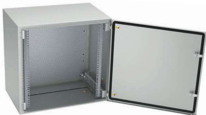
Шкаф SWN IP 65 с монтажной панелью и 19-дюймовыми монтажными профилями, окрашенный порошковой краской цвета RAL 7035. Внешние размеры: высота 575 мм, ширина 600 мм, глубина 400 мм. Полезная высота 12U. Исполнения со сплошной и стеклянной дверью
