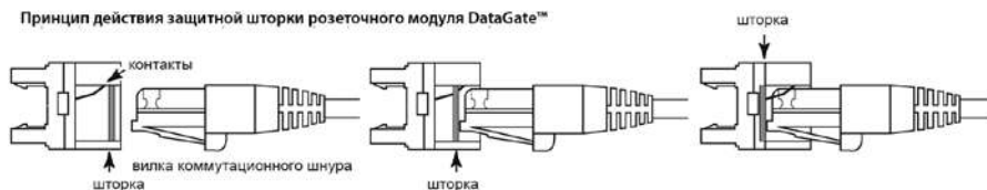
Принцип действия защитной шторки розеточного модуля DataGate™
