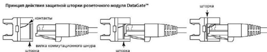
Принцип действия защитной шторки розеточного модуля DataGate™
