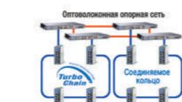
Технологию Turbo Chain позволяет снизить затраты за счет более низких требований к прокладыванию кабелей и портам Ethernet.
