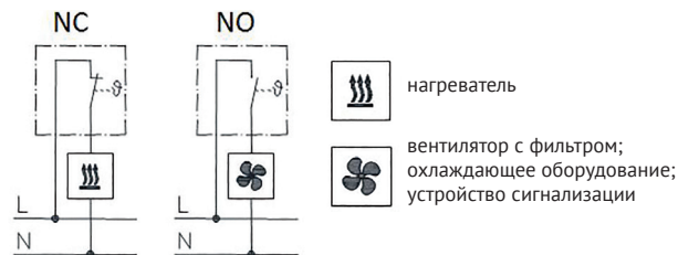
Схема подключения термостата
