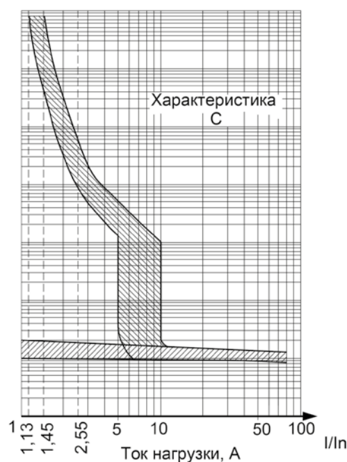
Защитная характеристика в условиях действия сверхтоков при контрольной температуре плюс 30°+5°С, с холодного состояния, при пропускании тока через все защищенные полюса АДТ
